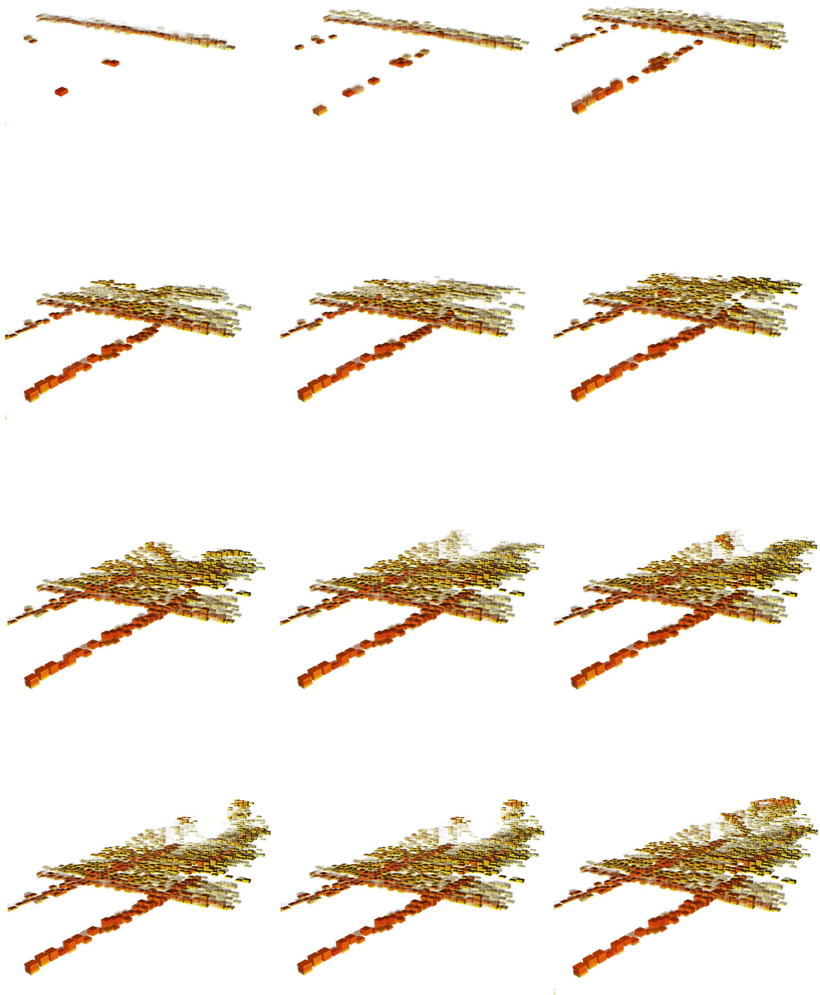
Abbildung 6.3: Sukzessiver Aufbau der Urkarte des Weltmodells: Die Belegheitswahrscheinlichkeit wird durch den Füllgrad der Kästchen symbolisiert, der Farbwert markiert die Zuverlässigkeit – je höher der Rotanteil, desto höher. Gut sichtbar ist die Spur der Füße.
