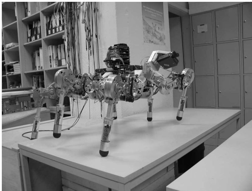
Abbildung 6.13: LAURON beim Versuch, eine Spalte zwischen zwei Tischen zu überqueren
