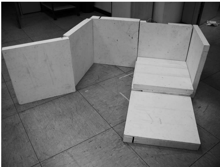
Abbildung 6.1: Test-Szenario für den Versuch zur Kartierung: Eine Sackgasse mit Stufen in verschiedenen Höhen, in die LAURON hinein laufen soll.
