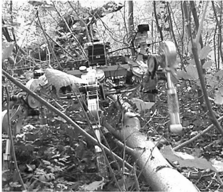
Abbildung 2.3: Die Laufmaschine LAURON im Einsatz in einem Waldgebiet
